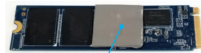
M.2 SSD裏側への熱伝導シート貼付け例
