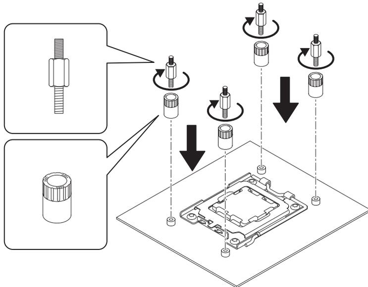
**4** ドライバーで、M3手回しねじを締めて水冷ポンプヘッドキャップを固定します。
