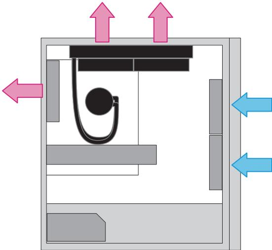
本製品のファンを吸気とするか排気とするかは、ファンの取り付け方向によって決定します。ファンの空気を流す方向とファンの回転方向は、ファンの側面の矢印または三角記号で示されています。
